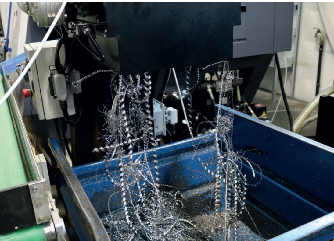
Il truciolo lungo e a matassa, nemico di ogni lavorazione
